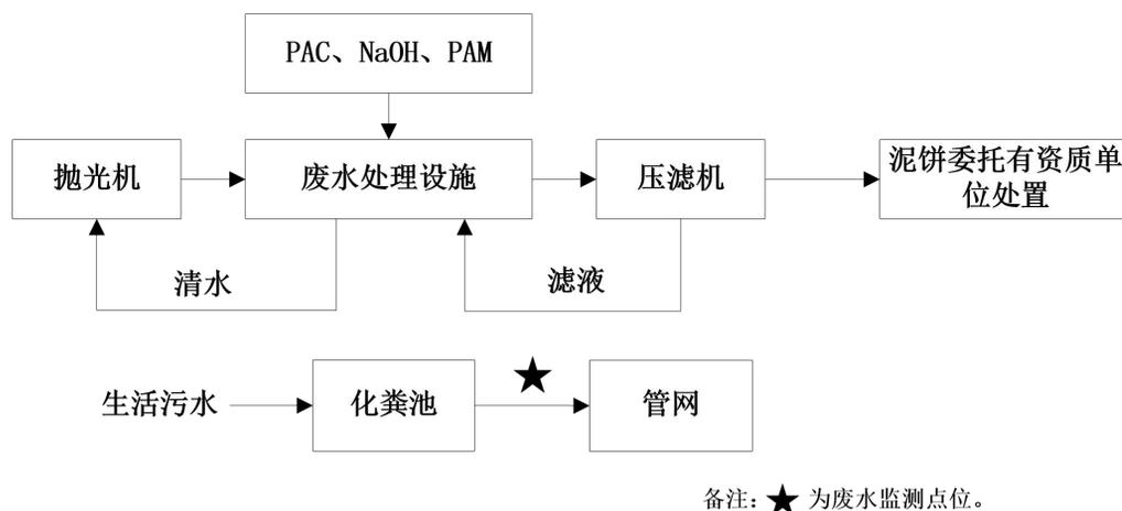
图4-1 废水处理设施流程图
