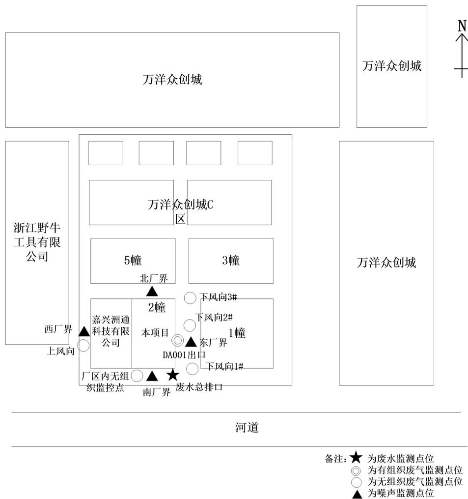
图 3-2 周边情况示意图及监测点位示意图
